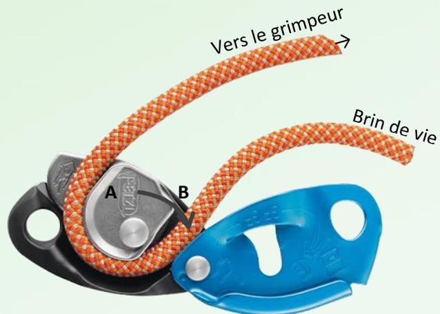
Le grigri (ou *gwigwi* en *Afwicain*) en position ouverte laisse apparaître son fonctionnement. Une came mobile (Rep A) se déplace par rotation (Rep B) pour venir écraser la corde contre la partie fixe du bâti. La rotation de la came est déclenchée automatiquement par la chute du grimpeur.
